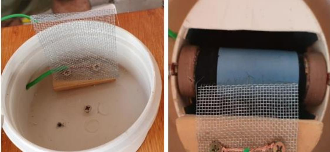
Figura 37: À esquerda a escova metálica inferior, e à direita a escova superior.
