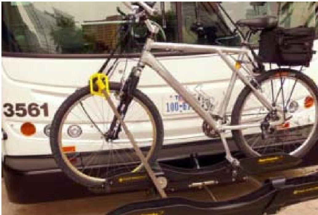
Figura 3 - Ônibus em Houston com dispositivo capaz de levar bicicletas
